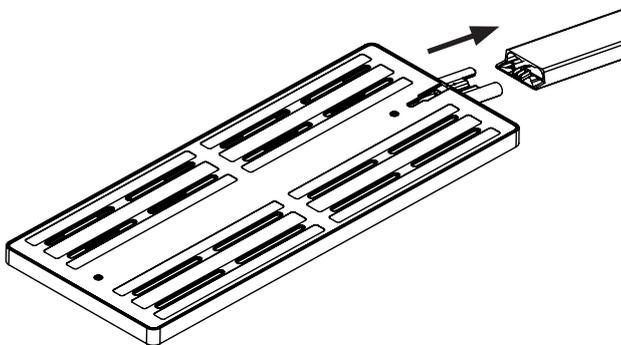
Leuchtenkopf langsam bis zum Anschlag in das Leuchtenrohr einschieben, dadurch werden automatisch alle elektrischen Verbindungen hergestellt.
