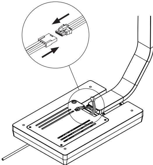
Steckverbindung hier positionieren !
