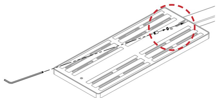
Der Leuchtenkopf wird über eine Innensechskantmutter mit Zahnscheibe gesichert. Schraube nur leicht anziehen !
