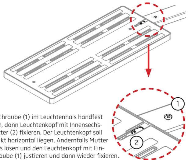
Einstellschraube (1) im Leuchtenhals handfest anziehen, dann Leuchtenkopf mit Innensechskantmutter (2) fixieren. Der Leuchtenkopf soll jetzt exakt horizontal liegen. Andernfalls Mutter (2) etwas lösen und den Leuchtenkopf mit Einstellschraube (1) justieren und dann wieder fixieren.
