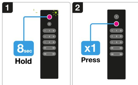
1. Halten Sie die Ein/Aus-Taste der Fernbedienung gedrückt, bis die grüne LED-Anzeige dauerhaft grün leuchtet.
