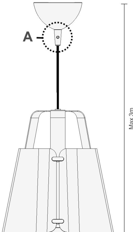
Kabellängden justeras genom att lossa på skruven i takkoppen (A).
