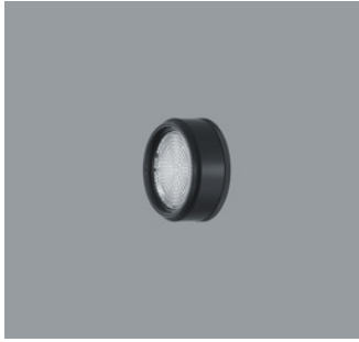
AC002122 Lens Unit zoom spot Kunststoff, schwarz lackiert, 360° drehbar. Werkzeuglos wechselbar. Entspiegelte Zoomlinse aus optischem Polymer, stufenlos fokussierbar.
