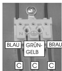
5. Versetzen Sie nun alle drei Kabel die in die Leuchte führen mit einem Silikonschlauch [C] aus dem mitgelieferten Montagekit. Die Silikonschläuche schützen die Kabel vor den hohen Temperaturen die in der Leuchte entstehen.
