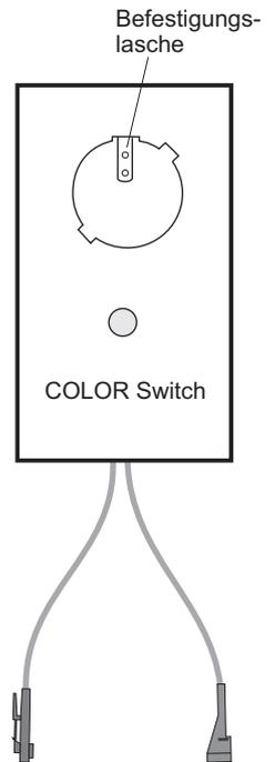
Mit dem Schalter lassen sich alle angeschlossenen Leuchten Ein- und Ausschalten sowie in der Lichtfarbe verändern.
