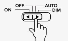
**DIM:** Leuchte ist stark gedimmt und wird hell bei Bewegungserkennung.
