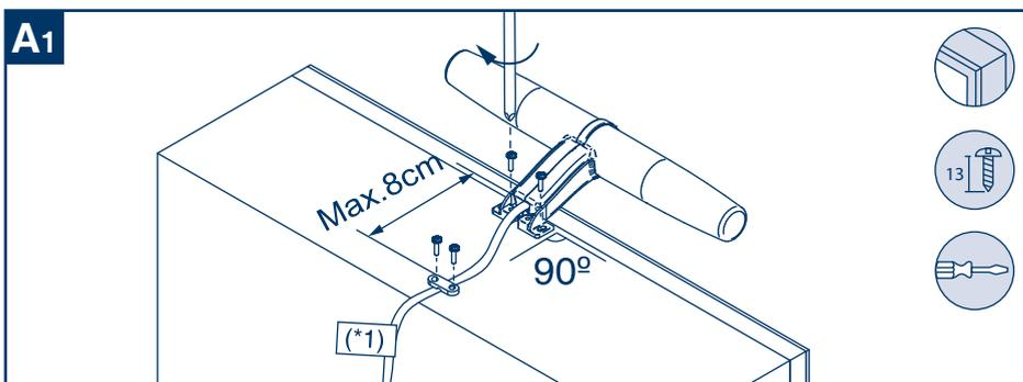
Sistema de enganche a madera / Attachment to wood / Système d'accrochage sur panneau miroir / Система крепления на деревянное покрытие
