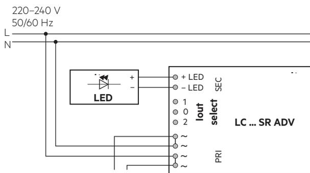
Gerät mit Durchgangsverdrahtungsfunktion.
