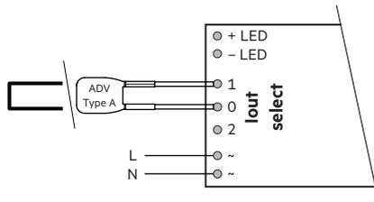
**1.400 mA:** Klemmen 0 und 2 verbunden mit 0 Ω Draht (max. 6 cm Länge) oder Widerstand ADV Plug Type A BR (Artikelnummer: 28001771)
