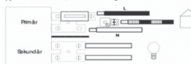
Typ.4: Schutzklasse I, Niedervolthalogen mit Schutzleiter
