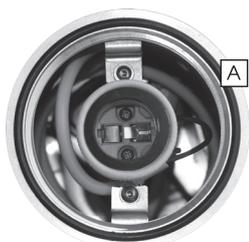
7. Legen Sie den O- Ring [A] so auf den Aluring, dass er zwischen dem Glas und dem Bund abdichtet. Setzen Sie nun das passende Leuchtmittel mit maximal 100 Watt in die vorgesehene Fassung.
