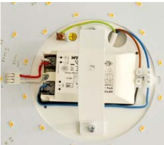
Dann den elektrischen Anschluss vornehmen. Der Erdleiter (Kabelmarkierung Gelb/Grün) wird an der Metallklammer angeschlossen. Phase und Nullleiter werden an den beiden Schraubklemmen angeschlossen.
