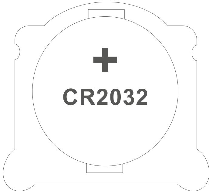
**!** De geplaatste lithium-knoopcel moet kortsluitvast zijn. Gebruik alleen de meegeleverde batterijhouder en geen metalen voorwerpen, zoals bijv. een tang of pincet om de batterij te plaatsen.
