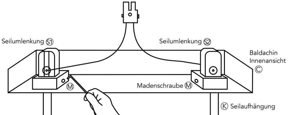
Aufgrund der Natürlichkeit des Materials Holz und seiner eigenen Holzdicke variiert das Eigengewicht eines jeden HerzBlut-Leuchtenkörpers ①. Die Gegengewichte ② sind auf ein Durchschnittsgewicht abgestimmt. Wenn der Leuchtenkörper ① schwerer als sein Gegengewicht ist, muss die „zusätzliche Last“ aufgefangen werden.
