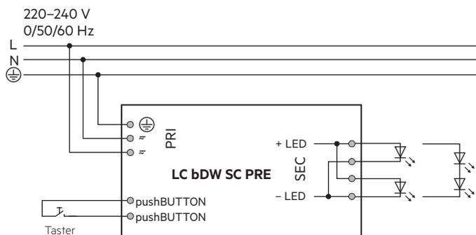
Der verwendete Taster muss über eine Isolation verfügen.
