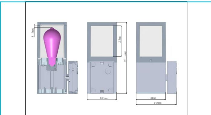
Die Wandleuchte FACADO ist unsere flexible Lösung für die Außenbeleuchtung. Durch zwei Kabeleinführungen ist eine Durchgangsverdrahtung problemlos möglich. Durch die abnehmbare Montageplatte mit Steckverbindung und die schraublosen Anschlussklemmen ist eine einfache und schnelle Montage problemlos möglich. Der neu entwickelte Leuchtenkopf sorgt für eine noch bessere Ausleuchtung. Durch die Schutzart IP 65 ist sie zudem besonders witterungsbeständig.
