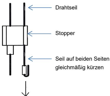
Das Drahtseil nach unten aus dem Stopper ziehen und auf beiden Seiten auf die gewünschte Länge kürzen
