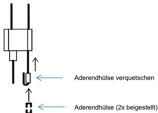
Die Aderendhülle über das Drahtseil schieben und das Seil ca 7 mm überstehen lassen. Jetzt die Aderendhülle mit einer Kombizange fest verquetschen. Dann das überstehende Seilstück umlegen und zurück in die Bohrung des Stoppers schieben.
