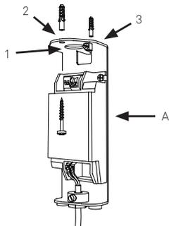
Bohren Sie die Löcher in der Decke (**Lochabstand: 48mm, Bohrerdurchmesser für mitgelieferte Dübel: Ø 5mm**). Führen Sie das Deckenkabel durch das Loch (1) der Halterung (A). Verwenden Sie geeignete Dübel und Schrauben und schrauben Sie die Halterung an den Löchern (2) + (3) an die Decke.
