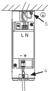
Führen Sie das Leuchtenkabel zuerst durch das Loch im Baldachingehäuse (B) und dann durch die Zugentlastung im unteren Bereich der Halterung (4). Schließen Sie anschließend das Kabel an das Netzteil an (+ braun, - weiß) und schrauben Sie die Zugentlastungsschraube fest ein.
