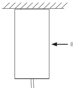
Schieben Sie das Baldachingehäuse nach oben bis es vom Magneten gehalten wird. Zwischen Baldachingehäuse und Decke findet sich eine Schattenfuge.
