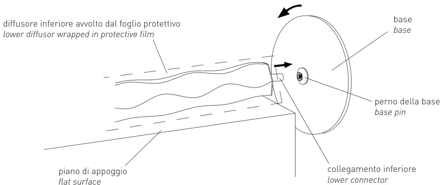
Far sporgere il diffusore inferiore dal piano di appoggio. Posizionare il perno della base perpendicolare allo snodo inferiore e ruotare la base in senso orario fino a fine corsa.
