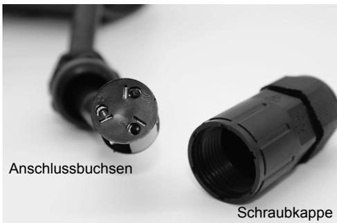
4. Lösen Sie nun die Schraubkappe der Stecker Verbindung. Ziehen Sie ihre Zuleitung durch das lose Ende der Schraubkappe, achten Sie hierbei darauf das die Dichtung in der Schraubkappe nicht verrutscht.
