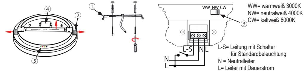
1. Deckenhalter ① von der Leuchte abnehmen (Federsperre ② nach außen ziehen).
