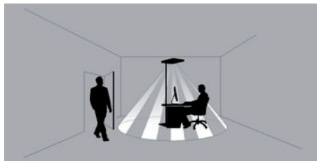
Fig. 17: Area di rilevamento sensore PIR.
