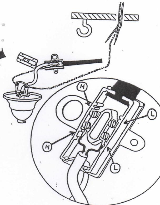
NL - Schakel de elektriciteit tijdelijk uit alvorens het toestel te plaatsen. Aansluiten aan de netspanningsdraden. Verbinden aan de netspanningsdraden bij middel van een lusterklem of kroonsteenje. De fabrikant aanvaardt geen enkele aansprakelijkheid voor letsel of schade als gevolg van een verkeerde toepassing van het verlichtingsapparaat. Raadpleeg een vakman in geval van twijfel.
