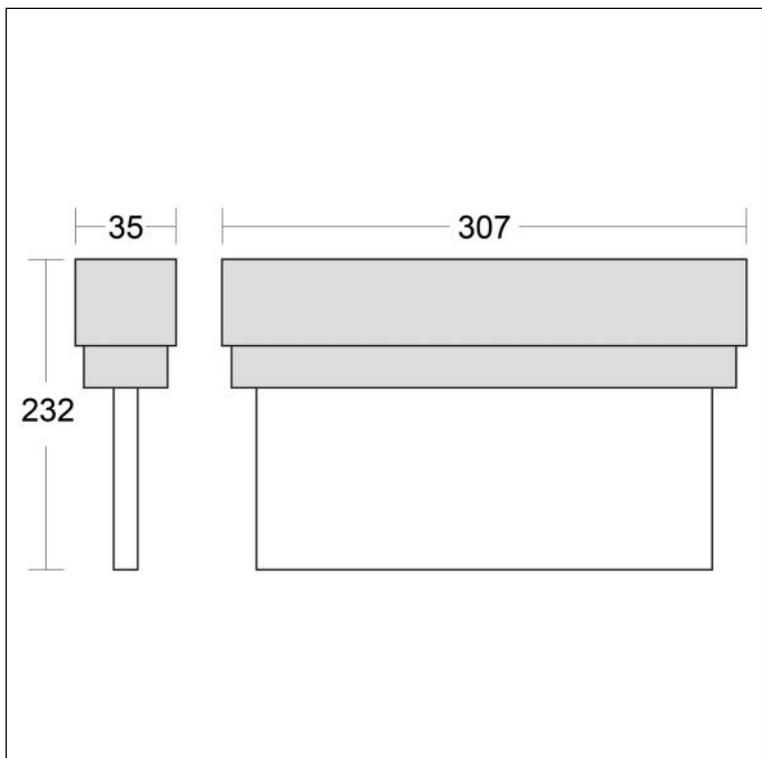
Formschöne und moderne LED-Scheibenleuchte für universelle Montage, als Einzelbatterie-Notleuchte mit manueller Testfunktion, Signalisierung über 1x mehrfarbige LED, inklusive Prüftaster. Gemäß DIN EN 60598-1, DIN EN 60598-2-22, DIN EN 62034 und DIN EN 1838 für Anlagen gemäß DIN VDE 0108 zum separaten Betrieb.
