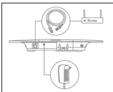
Schließen Sie zuerst das beiliegende LAN-Kabel an der Unterseite der Smartvest an und verbinden Sie dieses mit Ihrem Router.
