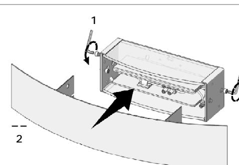
Riposizionare la fascia (2) fissandola mediante le apposite viti (1).
