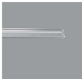
13965.000 Einputzprofil zur deckenbündigen Montage von ERCO Minirail Stromschiene 48V in Putzdecken. Aluminiumprofil. Für Deckenstärke 12,5mm. L 3000mm, H 34mm. Gewicht 2,25kg
