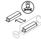
Устройство управления допускает замену квалифицированным электриком
