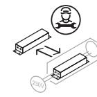
Appareil de commande remplaçable par un électricien
