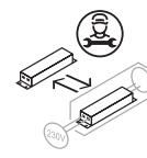
Betriebsgerät austauschbar durch eine Elektro-Fachkraft
