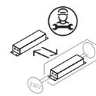
Możliwość wymiany urządzenia sterującego przez elektryka
