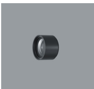
AC002004 Lens Unit flood Kunststoff, schwarz lackiert, 360° drehbar. Werkzeuglos wechselbar. Darklight Linse aus optischem Polymer. Optischer cut-off 40°.
