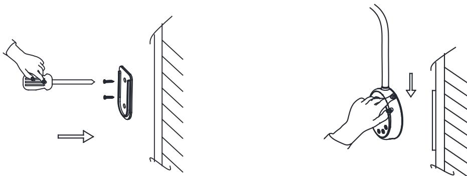
Méthode 2 : Fixer le clou en plastique sur le mur, puis fixer la plaque de support sur le mur à l'aide de vis, et faire glisser la lampe sur la plaque de support.
