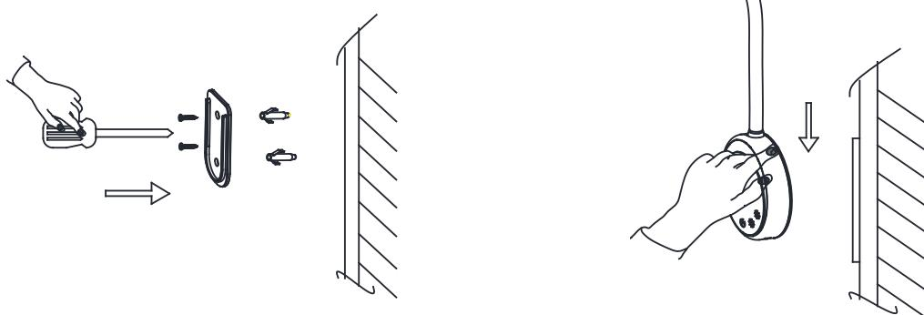
Méthode 3 : coller le ruban adhésif sur la surface de la plaque de support, la fixer au mur et faire glisser la base de la lampe sur la plaque de support.
