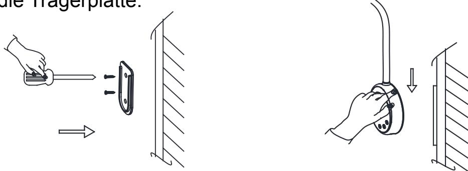
Methode 2: Befestigen Sie den Kunststoff-Klebenagel an der Wand, dann befestigen Sie die Trägerplatte mit Schrauben an der Wand und schieben Sie die Lampe auf die Trägerplatte.
