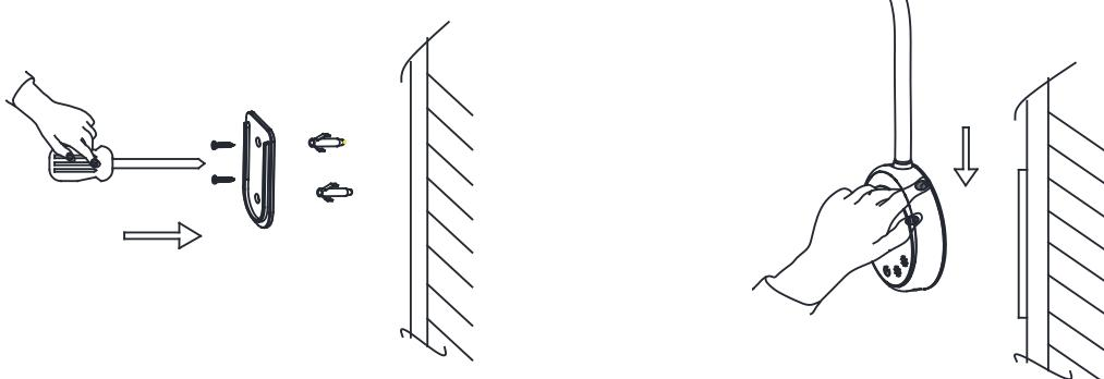
Methode 3: Kleben Sie das selbstklebende Band auf die Oberfläche der Trägerplatte, befestigen Sie sie an der Wand und schieben Sie den Lampensockel auf die Trägerplatte.
