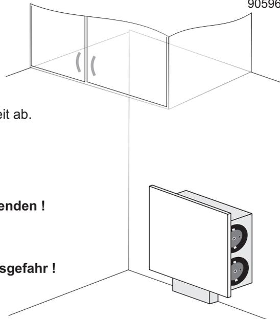
4. den PowerQuad mit den Schlüssellöchern über die Schrauben drücken und nach unten bis zum Anschlag schieben. Dabei darauf achten, dass das Anschlusskabel nicht geknickt oder beschädigt wird.
