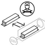
Betriebsgerät austauschbar durch eine Elektro-Fachkraft
