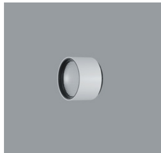
AC002039 Lens Unit oval wide flood Kunststoff, weiß, 360° drehbar. Werk- zeuglos wechselbar. Entspiegelte Spherolitlinse aus opti- schem Polymer.
