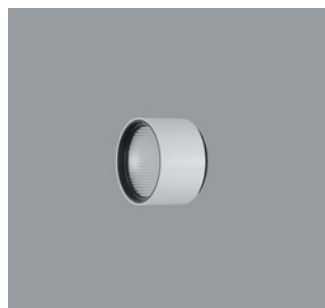
AC002037 Lens Unit wallwash Kunststoff, weiß, 360° drehbar. Werk- zeuglos wechselbar. Entspiegelte Spherolitlinse aus opti- schem Polymer.
