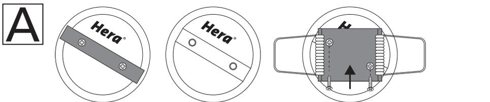
Vorhandene Haltefeder rückseitig abschrauben. Montagefeder mit den dafür vorgesehenen Schrauben montieren.
