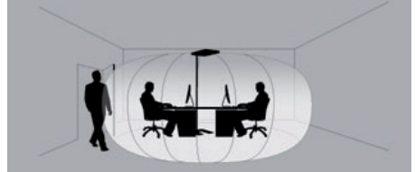
Fig. 11: Erfassungsbereich HFMD Sensor.
