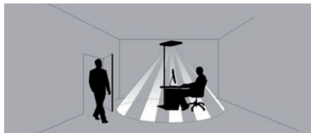
Fig. 12: Zone de détection de Détecteur PIR.
