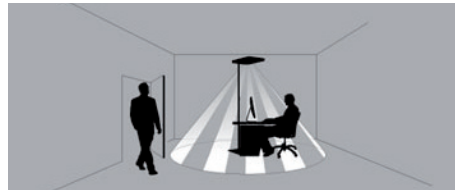
Fig. 12: Erfassungsbereich PIR Sensor.
