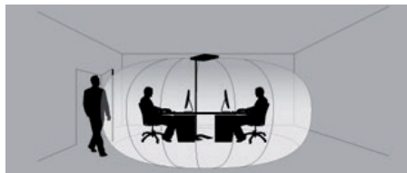
Fig. 11: Campo d'azione di HFMD sensore.
