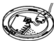
Der Bereich vor dem Bayonettverschluss (auf dem Bild gepunktet) ist KEIN Installationsbereich. Somit dürfen dort keine Adern geführt werden. Durch die Mechanische Bewegung des Verschließens könnten die Adern verletzt werden.
