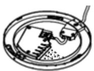
La zone devant la serrure à baïonnette (pointillée sur l'image) n'est PAS une zone d'installation. Cela signifie qu'aucun fil ne peut y être acheminé. Le câble pourraient être endommagées par le mouvement mécanique de la fermeture.
