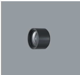
AC002006 Lens Unit spot Kunststoff, schwarz lackiert, 360° drehbar. Werkzeuglos wechselbar. Darklight Linse aus optischem Polymer. Optischer cut-off 50°.
