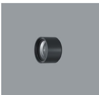
AC002002 Lens Unit wide flood Kunststoff, schwarz lackiert, 360° drehbar. Werkzeuglos wechselbar. Darklight Linse aus optischem Polymer. Optischer cut-off 40°.
