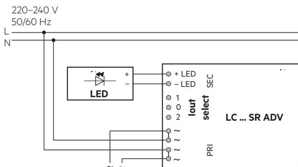
Gerät mit Durchgangsverdrahtungsfunktion.
