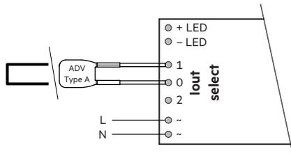
**1.050 mA:** Klemmen 0 und 2 verbunden mit 0 Ω Draht (max. 6 cm Länge) oder Widerstand ADV Plug Type A BR (Artikelnummer: 28001771)
