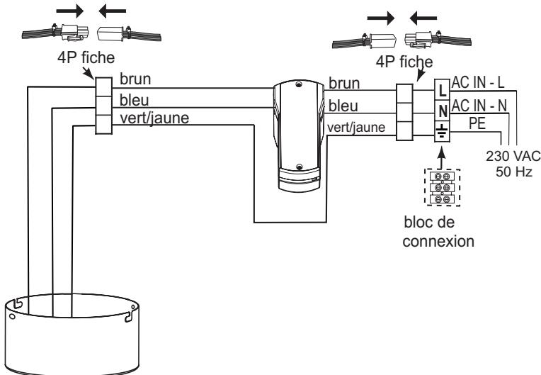
Branchez les fiches comme montré dans l'image et connecter la tension d'alimentation sur le bornier.
