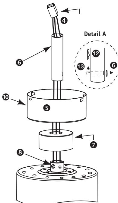
**DE** Setzen Sie den Baldachin und die Abdeckung der Aufnahme der Deckenstange wie gezeigt mit der Deckenstange zusammen. Lösen Sie die beiden Schrauben an der Deckenstangenaufnahme am Motor und führen sie die Deckenstange ein.
