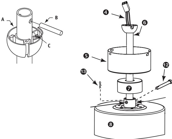
**[DE]** Stecken Sie die Halbkugel (A) auf die Deckenstange. Stecken Sie nun den Stift (B) in die Bohrung der Deckenstange und schieben Sie die Halbkugel nach oben. Fixieren Sie die Halbkugel auf der Deckenstange, indem Sie die Schraube (C) fest anziehen.
