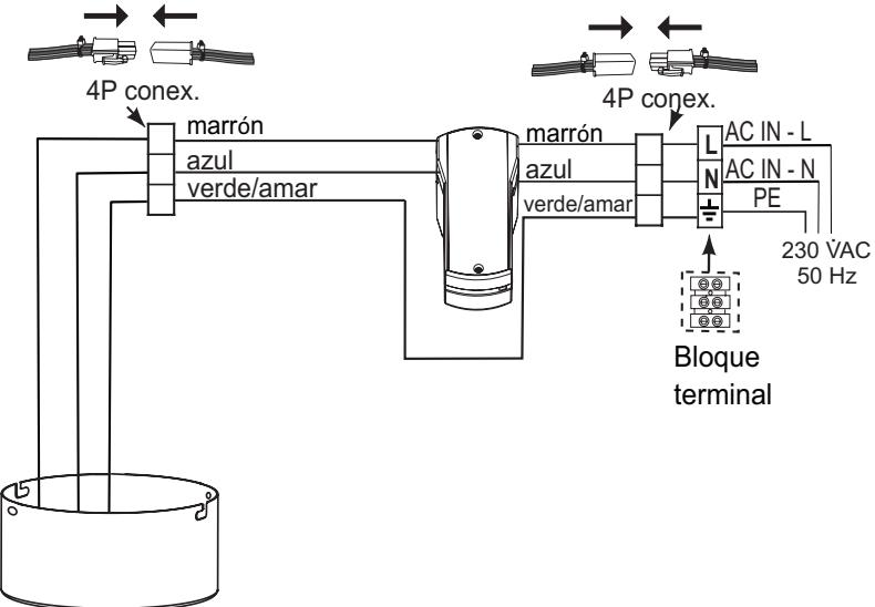
Conecte como se muestra en la imagen y conecte la tensión de la red en el bloque de terminales.
