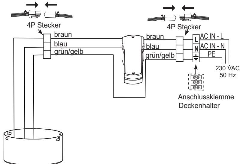
Verbinden Sie die Stecker wie in der Abbildung gezeigt und schließen Sie die Netzspannung an der Anschlussklemme an.
