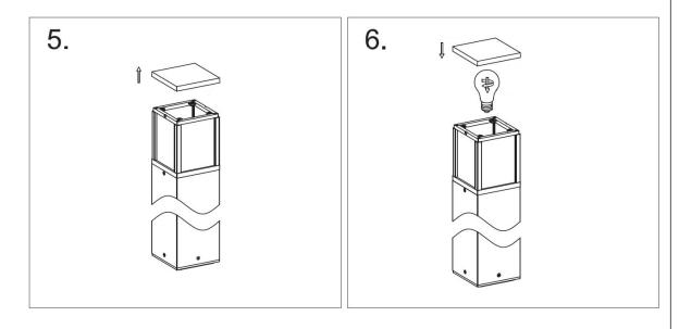
**5.** Zum Einsetzen des Leuchtmittels ziehen Sie bitte den Deckel an der Oberseite der Leuchte ab. Anschließend Schrauben Sie ihr Leuchtmittel ein und setzen den Deckel wieder auf. Hierbei ist darauf zu achten, dass der Deckel richtig sitzt um ein Eindringen von Feuchtigkeit zu verhindern.
