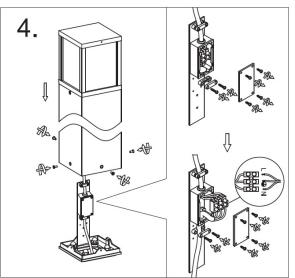
3. Zum Anschließen der Zuleitung verwenden Sie bitte das im Lieferumfang enthaltene Anschlussmaterial. Dabei ist wichtig darauf zu achten, dass alle Kabel in die richtige Öffnung geklemmt werden. Nullleiter (N), blaues Kabel. Erdung, grün-gelbes Kabel. Phase (L), braunes oder schwarzes Kabel. Vor dem Anklemmen muss bei jedem Kabel ein Stück der Isolierung entfernt werden.
