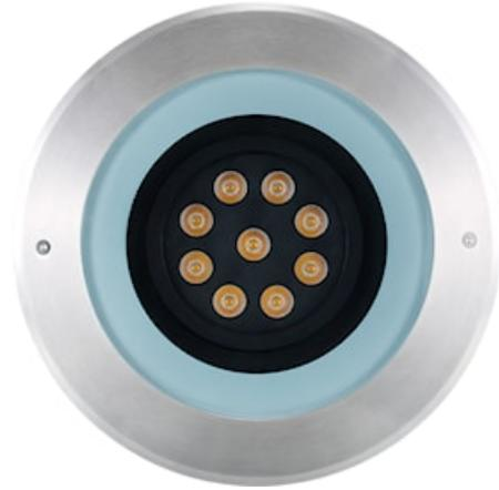
Runde Bodeneinbauleuchte mit +/-30° verstellbarem Lichtmodul, überfahrbar für Druckbelastungen bis 2000kg (20kN), mit 2m 3x1 mm<sup>2</sup> Flugkabel und Einbaurohr, Aluminiumgehäuse mit Zierring aus Edelstahl (SS316) und Klarglasdiffusor, IP67, IK10, Klasse I, nicht dimmbar, 2.000 lm, 29 W, 69 lm/W, CRI80, 25° Ausstrahlungswinkel, 50.000 Stunden L70 B50 Lichtstromerhalt, 260 mm Durchmesser, 265 mm Einbaurohrhöhe, 3,5kg Gewicht.
