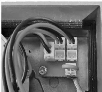
**5.** Es ist möglich den oberen oder unteren Lichtkegel auszuschalten indem man die innenliegende Steckerbrücke (der Stecker mit dem kleinen Stück Kabel) in einen der freien Buchsen einsetzt.
