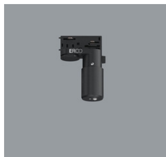
55249.000 ERCO Casambi Bewegungsmelder mit Lichtsensordetektor für ERCO Stromschienen 220-240V. Einrichtung über Casambi App (Android/iOS) mit Bluetooth Low Energy (BLE) fähigen Mobilgeräten. Anwendung zur tageslichtabhängigen Lichtsteuerung mit oder ohne Bewe- gungsmelder. Erfassungsbereich des Infrarot (PIR) Sensors 100° / 5m. Bei 3m Raumhöhe ist dies ein Kreis von ca. 7m Durchmesser. 3-Phasen-Adapter für ERCO Strom- schiene 220-240V: Kunststoff, schwarz. Schwarz Gewicht 0,18kg CE RoHS
