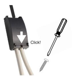
Nach Anschluss Press-Zugentlastung einrasten und mit Schraube sichern! After connection, snap in press strain
