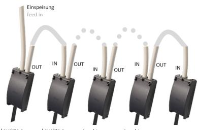
Leuchte o. Netzgerät light or driver Leuchte o. Netzgerät light or driver
