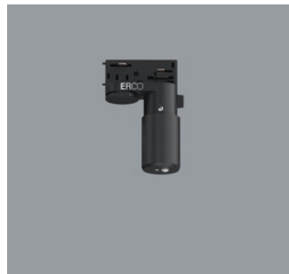
55249.000 ERCO Casambi Bewegungsmelder mit Lichtsensoren für ERCO Stromschienen 220-240V. Einrichtung über Casambi App (Android/iOS) mit Bluetooth Low Energy (BLE) fähigen Mobilgeräten. Anwendung zur tageslichtabhängigen Lichtsteuerung mit oder ohne Bewe- gungsmelder. Erfassungsbereich des Infrarot (PIR) Sensors 100°/ 5m. Bei 3m Raumhöhe ist dies ein Kreis von ca. 7m Durchmesser. 3-Phasen-Adapter für ERCO Strom- schiene 220-240V: Kunststoff, schwarz. Schwarz Gewicht 0,18kg RoHS CE
