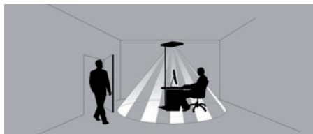
Fig. 12: Campo d'azione di PIR sensore.
