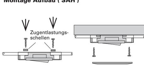
Die Zugentlastungsschellen müssen wie in der Skizze gezeigt auf die Rückseite des Schaltergehäuses geschraubt werden.
