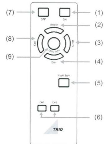
**¡Atención! Un escenario de luz ajustado mediante el mando a distancia será desechado si se apaga la luminaria mediante el interruptor de pared.**
