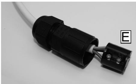
6. Setzen Sie jetzt das Gehäuserohr auf den Leuchtenfuß, achten Sie darauf, dass Sie das Kabel nicht zwischen Fuß und Gehäuse einklemmen. Befestigen Sie nun wieder alle Schrauben.
