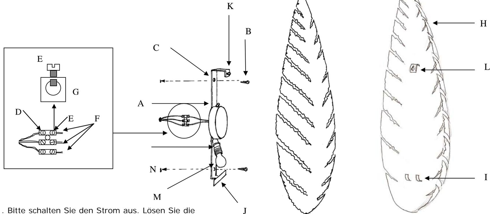
1. Bitte schalten Sie den Strom aus. Lösen Sie die Schrauben (E) der Lüsterklemme (D) indem Sie diese gegen den Uhrzeigersinn mit einem Schraubendreher heraus schrauben.
